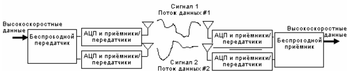
Рис. 3.1. Принцип работы Wi-Fi с интеллектуальной антенной MIMO
