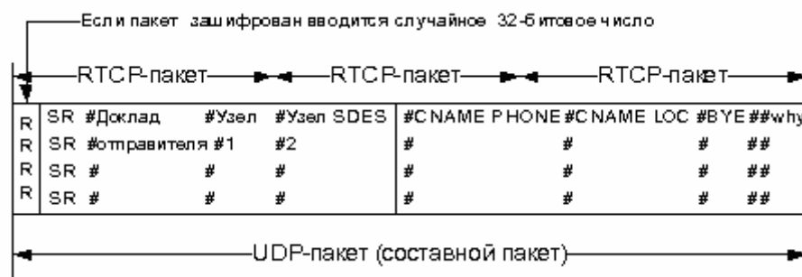
Рис.5 Пример составного пакета RTCP (#: SSRC/CSRC)
