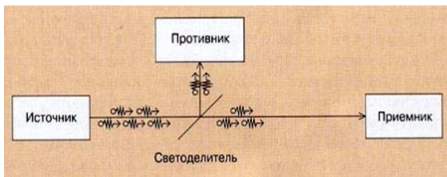
Схема 9. Использование многофотонных импульсов для передачи сигнала делает возможным перехват данных путем «отвода» части фотонов
